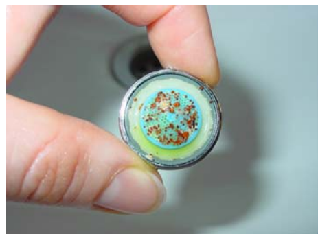
Slika 3: odloženi delce rje na mrežici iztočnega mesta
