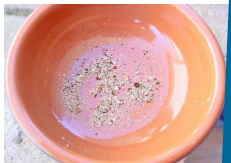
Slika 4: odloženi delci vodnega kamna po čiščenju interne instalacije
